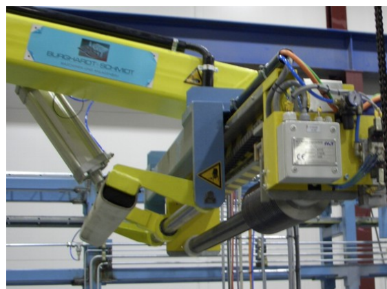
Separierwelle am Aufwickelhaspel Schweden – Långshyttan
