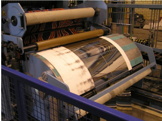
2006 - 180x910 Rollenkorb am Einlauf des Bremswagens Outokumpu Stainless AB
