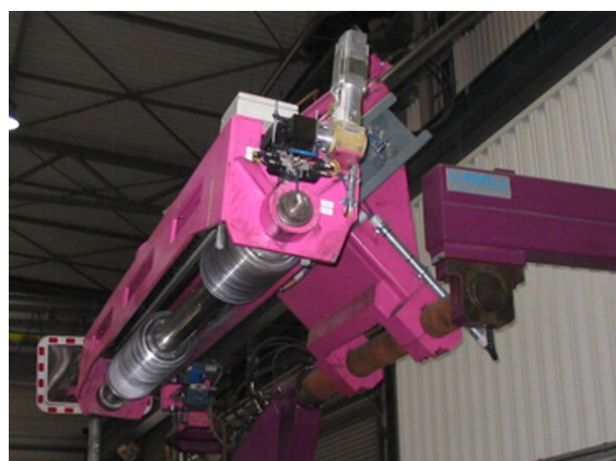
Separierwelle am Aufwickelhaspel Niederlande – Moerdijk
