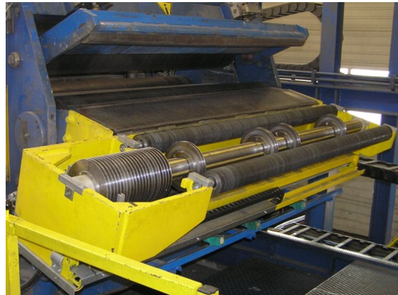
Separierwelle am Auslauf des Bremswagens Deutschland – Norden
