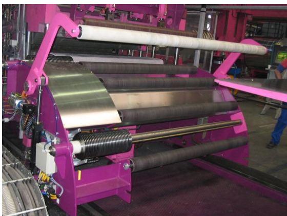
2005 - 240x1650 Rollenkorb am Einlauf des Bremswagens WUPPERMANN Staal Nederland B.V.
