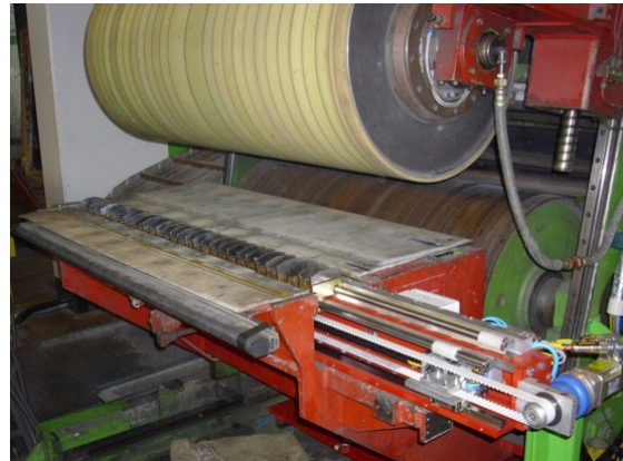
Separierkasten am Auslauf Bremswagen Deutschland - Bochum
