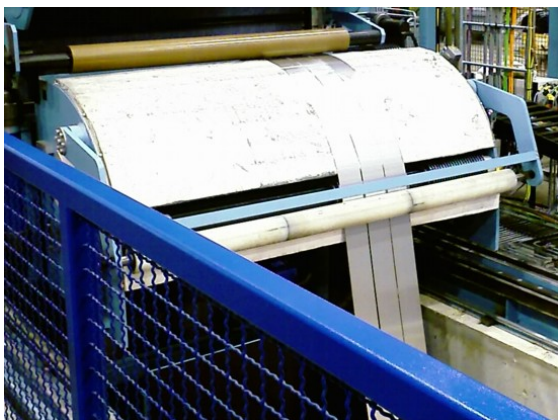
2007 - 210x1150 Rollenkorb am Einlauf des Bremswagens Outokumpu Stainless AB
